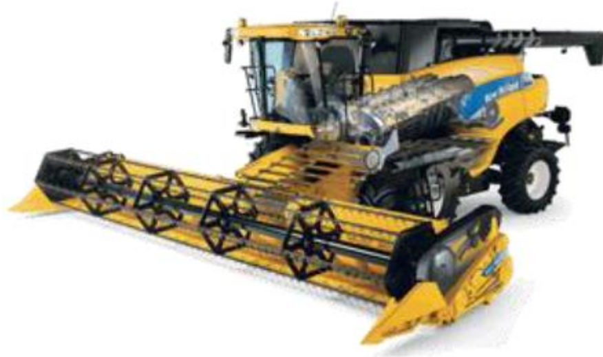
Figura 7 – Colhedora equipada com sistema de trilha radial de duplo rotor.
