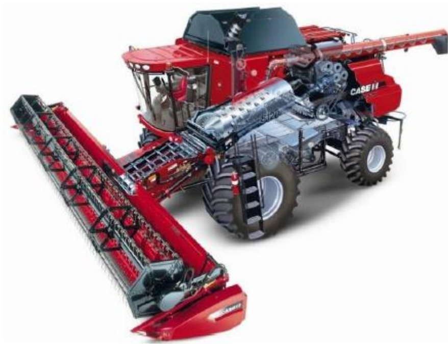
Figura 6 – Colhedora automotriz equipada com sistema de trilha axial.
