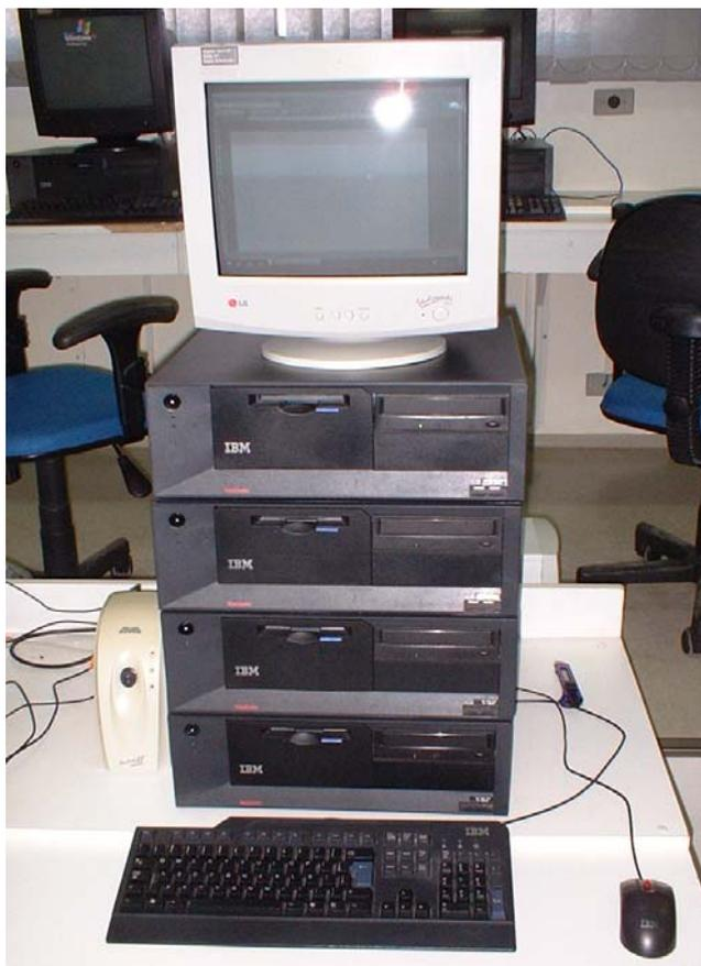
Figura 1 – Cluster baseado na Arquitetura Beowulf utilizado no projeto (PRIMO, 2005).
