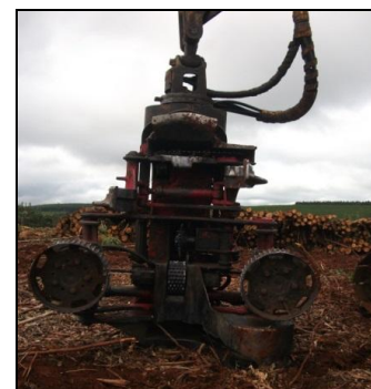
Figura 5. Máquina base CAT 541(a) e cabeçote processador Waratah 624(b).
