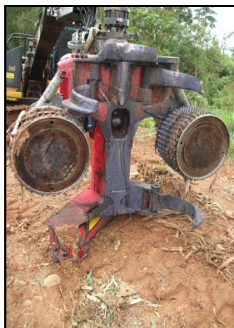
Figura 1. Harvester CAT 320D (a) e cabeçote Logmax 7000 (b), estudados nesta pesquisa.
