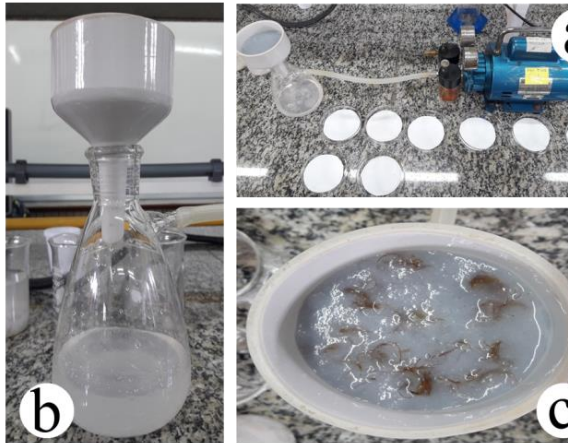
Figura 1: Bomba a vácuo (a) conectada ao kitasato com funil (b) e suspensão aquosa do papel reciclado com fibras de açaí (c).
