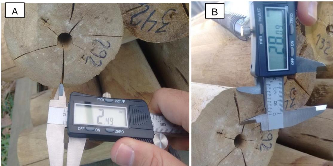
Figura 1 – Mensuração das aberturas e comprimentos das rachaduras de topo de toretes torneados : A – abertura; B – comprimento.
