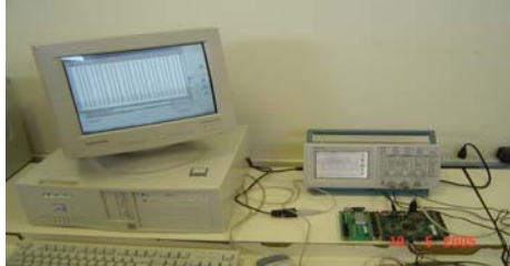
Figura 3 - Comunicação real com o PKCS#11 em hardware.
