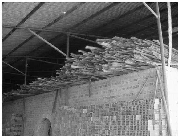
**Figura 3** - Armazenamento de costaneira de pinus sobre os fornos intermitentes, no município de Itabaiana.
