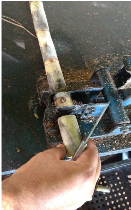
Foto 1. Guilhotina para extração de minirrebolos de Cana-de-Açúcar para produção de Mudas-Pré-Brotadas
