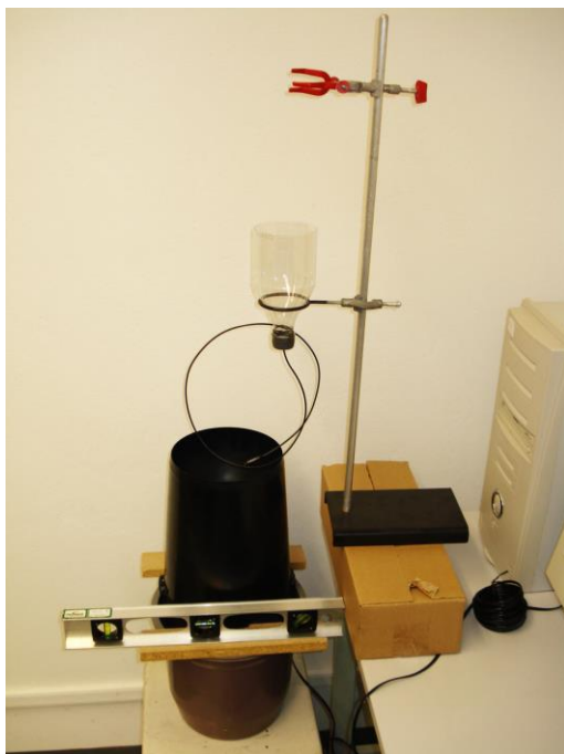
Figura 4. Estrutura do sistema montado para validação do Sistema de Verificação de Calibração de Pluviômetros.
