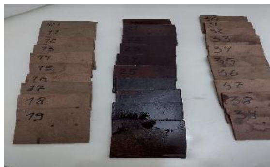
Figura 5 – Amostras de chapas de fibra HDF submetidas a diferentes condições ambientais por 7 dias
