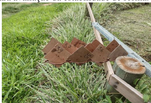
Figura 3 - T3 – Amostras dispostas em ambiente externo, “no tempo”, para avaliação da estabilidade de forma.
