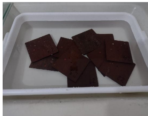
Figura 2 - T2 - Amostras imersas na água para avaliação da estabilidade de forma.
